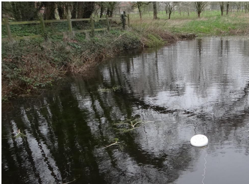
Figure 24 : Pose d'un Amphicapt au Prévôté De Gorre (Alfa-Environnement, 2020)
